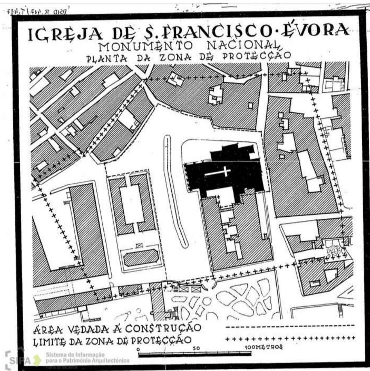
Figura 70. Igreja de S. Francisco. Planta da Zona de Protecção, Esc.1/50, com marcação dos limites das zonas de protecção e das zonas vedadas a construção. Desenho fornecido pelo SIPA, em JPEG.
